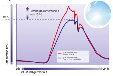
Tests am Beispiel eines unbelüfteten/unbeheizten Wintergartens zeigten eine Reduktion im Innenraum um bis zu 13°C im Vergleich zu Standardplatten. Das bedeutet: höchste Selektivität egal welches Wetter draußen herrscht.
