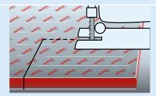
**9** | Oft ist ein Eckausschnitt nötig (z.B. für Rohrleitungen, Lüftungen usw.). Verwenden Sie eine Stichsäge ohne Pendelhub. Für Bohrungen können Sie Spiralbohrer (Spitzwinkel φ 110°-130°), Kegel oder Stufenbohrer verwenden.
