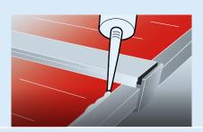
**14** | ... dichten die obere Dichtlippe des Abschlussprofils mit Exolon® verträglichem Silikonkautschuk ab und streichen alles glatt, damit kein Wasser eindringen kann.
