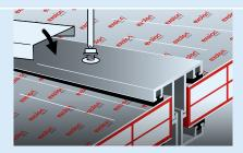
**12** | Die Oberprofile werden mit den empfohlenen Schrauben mit Dichtscheibe befestigt, vorher Schutzfolie zurückschlagen. Je nach Verlegesystem wird danach ein Deckprofil aufgebracht.
