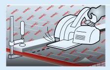
**6** | Das Anzeichnen erfolgt mit einem weichen Stift auf der Schutzfolie, die auch für die weitere Bearbeitung bis nach der Montage auf der Platte bleiben soll. Zum Schneiden benutzen Sie handelsübliche Kreissägen mit ungeschränktem Vielzahnsägeblatt und Hartmetallschneiden. Arbeiten Sie immer mit Anschlag.
