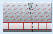
8 | Werden die Exolon® multi UV Platten in ihrer Breite reduziert, sägen Sie bitte möglichst nahe am nächsten Steg, um die optimale Klemmwirkung des Profils zu gewährleisten.
