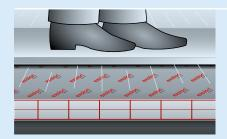
**11** | Legen Sie die Exolon® multi UV Platten auf die Sparren. Wichtig! Die UV Seite bitte immer nach außen bzw. oben legen. Die Kennzeichnung finden Sie auf der Schutzfolie und als Randprägung. Vermeiden Sie das Betreten der Platten. Wenn notwendig, legen Sie bitte quer zu den Platten eine Langbohle.
