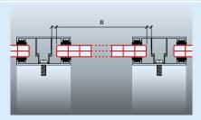
**4** | Die lichte Breite bzw. die Plattenbreite (B) von Exolon® multi UV Platten ergibt sich aus dem Sparrenabstand, den Abmessungen des gewählten Profils und dem notwendigen Dehnungsspiel (3 mm/m bei Polycarbonat).
