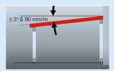
2 | Wir empfehlen Ihnen eine Dachneigung von mind. 5° (≜ 90 mm/m). So fließt das Regenwasser besser ab, die Verbindungen bleiben dicht und eine natürliche Reinigung durch das Regenwasser ist gewährleistet.
