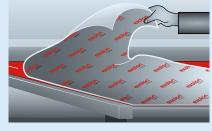
**13** | Am Schluss entfernen Sie die Schutzfolie von den Exolon® multi UV Platten die nicht länger als 24 Stunden unter Witterungsbedingungen bleiben soll. ...
