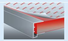
10 | Für das Verschließen der Plattenstirnseiten gibt es eine einfache, aber sehr wichtige Regel, um die Kondensatbildung möglichst gering zu halten: oben so dicht wie möglich (z.B. Abkleben der Kante mit Aluminiumband und Aufstecken eines Aluminium-Abschlussprofils, eventuell mit
