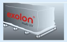
1 | Die Platten sollten möglichst horizontal und in Innenräumen gelagert werden. Bei Außenlagerung decken Sie die Exolon® multi UV Platten mit weißer Polyethylen (PE)-Folie ab.
