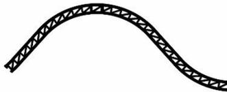
Die **Exolon® multi UV Onda** ist für die Herstellung von Oberlichtern in Kombination mit glasfaserverstärkten Paneelen oder für durchgehende Lichtbänder konzipiert.
